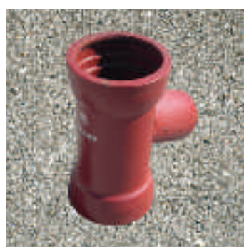
TI A 2 BICCHIERI CON DERIVAZIONE LISCIA A 67°30'
